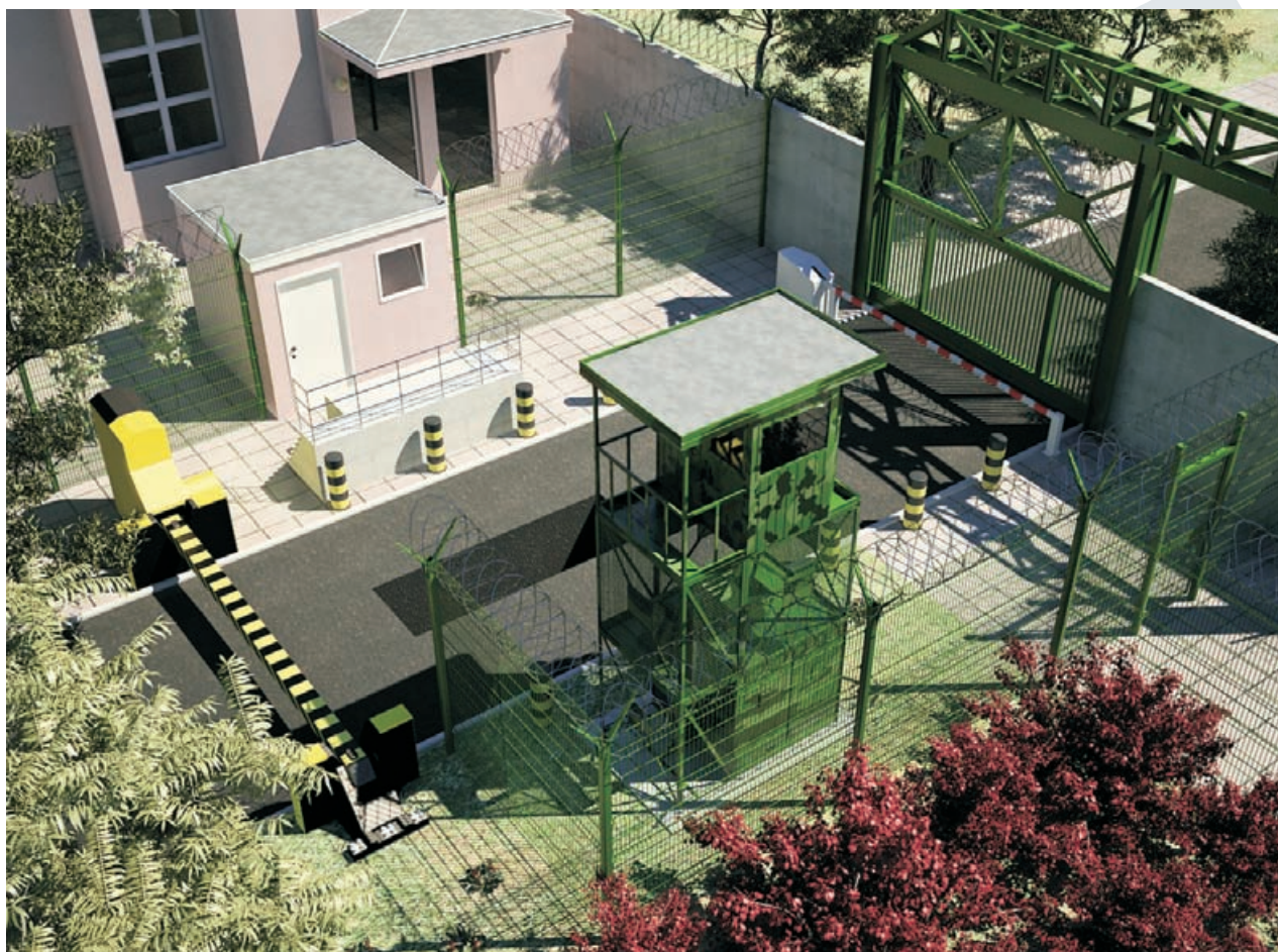
Вариант плана досмотровой зоны объекта с применением ПТУ
