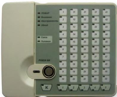
Блок индикации «Рубеж-БИ» предназначен для отображения состояния зон, групп зон и исполнительных устройств адресной системы пожарной сигнализации и пожаротушения на встроенном светодиодном табло. Блок конструктивно выполнен в пластмассовом корпу-
