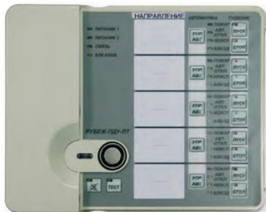
Пульт дистанционного управления «Рубеж-ПДУ-ПТ» (далее ПДУ-ПТ) предназначен для дистанционного управления режимами работы многозонной (до 5 зон) системой пожаротушения, подключенной в АЛС одного или нескольких приемно-контрольных приборов: «Рубеж-2АМ», «Рубеж-4А», «Рубеж-20П».
