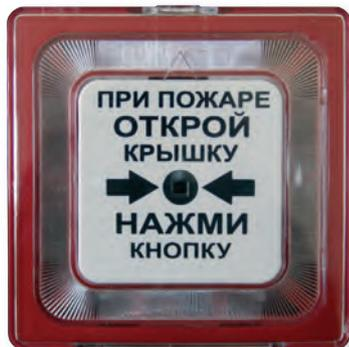
Извещатель пожарный ручной адресный ИПР 513-11 предназначен для ручного включения сигнала «Пожар» в адресных системах пожарной и охранно-пожарной сигнализации. Работает в составе адресной системы под управлением приемно-контрольного прибора «Рубеж-2АМ», «Рубеж-4А», «Рубеж-20П», ППКПУ серии «Водолей».
