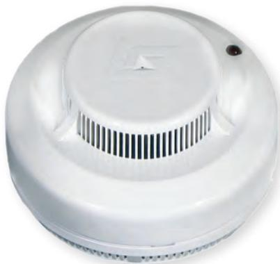
Извещатель пожарный дымовой оптико-электронный автономный ИП 212-142 предназначен для обнаружения загораний, сопровождающихся появлением дыма малой концентрации в закрытых помещениях различных зданий и сооружений, путем регистрации отраженного от частиц дыма оптического излучения и вы-
