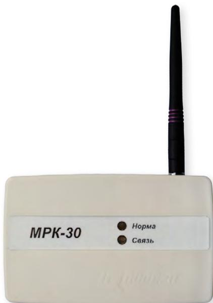
Модуль радиоканальный МРК-30 предназначен для интегрирования в адресную систему пожарной и охранно-пожарной сигнализации и пожаротушения тм Рубеж радиоканальных дымовых пожарных извещателей ИП 212-64Р и радиоканальных ручных пожарных извещателей ИП 513-11Р. Модуль радиоканальный МРК-30 работает под управлением приемно-контрольного прибора «Рубеж-2АМ», «Рубеж-4А», «Рубеж-2ОП», ППКПУ серии «Водолей».
