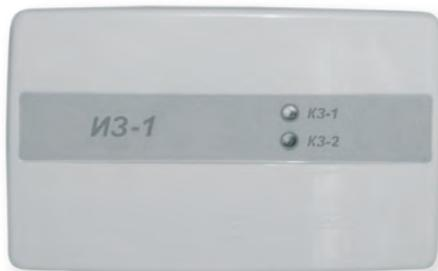
Изолятор шлейфа ИЗ-1 предназначен для использования в адресных линиях связи приемно-контрольных приборов «Рубеж-2АМ», «Рубеж-4А», «Рубеж-20П», ППК-ПУ серии «Водолей», входящих в систему пожарной сигнализации и пожаротушения тм РУБЕЖ. Изолятор шлейфа изолирует короткозамкнутые участки адресной линии связи, тем самым обеспечивая работоспособность остальной части линии связи. При устранении короткого замыкания изолятор шлейфа
