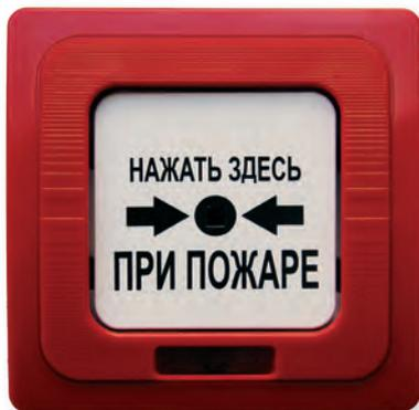
Извещатель пожарный ручной электроконтактный ИПР 513-10Э (далее в тексте – извещатель ручной) предназначен для ручной подачи сигнала «Пожар» в системах пожарной и охранно-пожарной сигнализации. Питание извещателя и передача сигнала «Пожар» осуществляется по двухпроводному шлейфу сигнализации.
