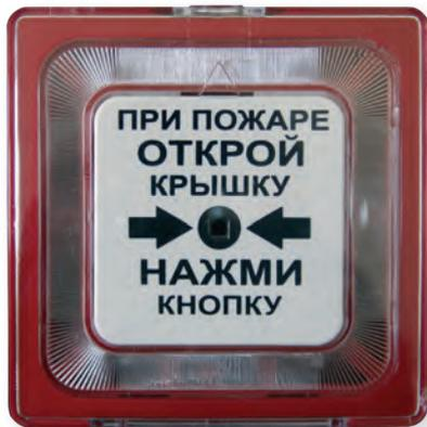
Извещатель пожарный ручной электроконтактный ИПР 513-10 (далее по тексту – извещатель) предназначен для ручного включения сигнала «Пожар» в системах пожарно-охранной сигнализации. Питание извещателя и передача сигнала «Пожар» осуществляется по двухпроводному шлейфу сигнализации. Сня-
