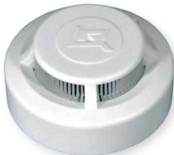
Извещатель пожарный дымовой оптико-электронный ИП 212-41М предназначен для раннего обнаружения загорания, сопровождающегося появлением дыма малой концентрации в закрытых помещениях различных зданий и сооружений. Питание извещателя и передача сигнала «Пожар» осуществляется по двухпроводному шлейфу сигнализации и сопровожда-
