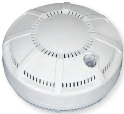
Извещатель пожарный дымовой оптико-электронный автономный ИП 212-50М2 предназначен для обнаружения загораний, сопровождающихся появлением дыма малой концентрации в закрытых помещениях различных зданий и сооружений, путем регистрации отраженного от частиц дыма оптического излучения и
