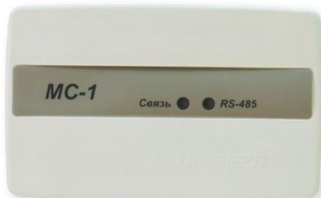
Модули сопряжения MC-1, MC-2 (далее – MC) представляют собой цифровые электронные устройства и предназначены для сопряжения адресных приемно-контрольных приборов «Рубеж-2АМ», «Рубеж-4А», «Рубеж-20П», ППКПУ серии «Водолей» с компьютером.
