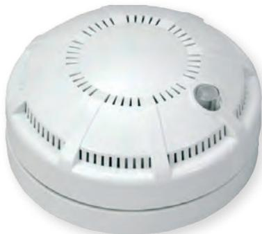
Извещатель пожарный дымовой оптико-электронный ИП 212-45 предназначен для раннего обнаружения загорания, сопровождающегося появлением дыма малой концентрации в закрытых помещениях различных зданий и сооружений. Питание извещателя и передача сигнала «Пожар» осуществляется по
