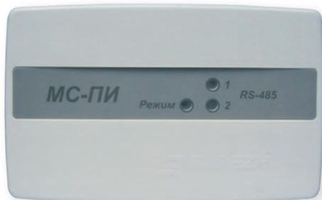
Повторитель интерфейса МС-ПИ представляет собой цифровое электронное устройство, предназначенное для увеличения длины линии интерфейса RS-485 с помощью повторения принимаемого сигнала.
