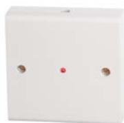
Предназначено для дублирования сигналов световой индикации ИПДЛ. Устройство устанавливается на удобной высоте и подключается проводами к выходным клеммам извещателя, позволяя оперативно определить режим работы ИПДЛ.
