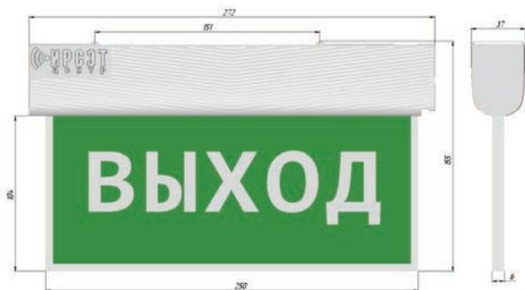
Табло оповещателя может содержать различные типы надписей («ВЫХОД», «ПОЖАР», «ГАЗ НЕ ВХОДИ», «ГАЗ УХОДИ», «АЭРОЗОЛЬ НЕ ВХОДИ», «АЭРОЗОЛЬ УХОДИ», «АВТОМАТИКА ВКЛЮЧЕНА» и др.), нанесенные методом шелкографии или гравировки и выполненные на цветном фоне или на просвет:
